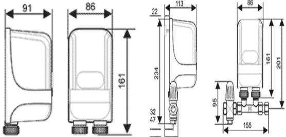
De taille compacte, les chauffe-eau DAFI sont de taille identique quelque soit leur puissance : 3,7 kW - 4,5 kW - 5,5 7,5 kW en monophasé - et 7,5 kW - 9 kW et 11 kW en triphasé.
