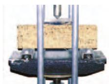
Suivant la mise en œuvre, la résistance à la compression atteint facilement 6 MPa et 3,5 MPa en flexion. Mis en œuvre avec une presse, on obtient 4 Mpa pour une densité de 650kg sans sable.
