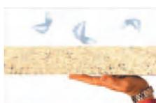
Jusqu'à 5 fois plus léger qu'un béton armé classique, la masse volumique du béton d'AGRESLITH-C commence à 500 kg/m<sup>3</sup> jusqu'à 1200 kg/m<sup>3</sup>. Il est considéré comme un béton léger ou très léger.
