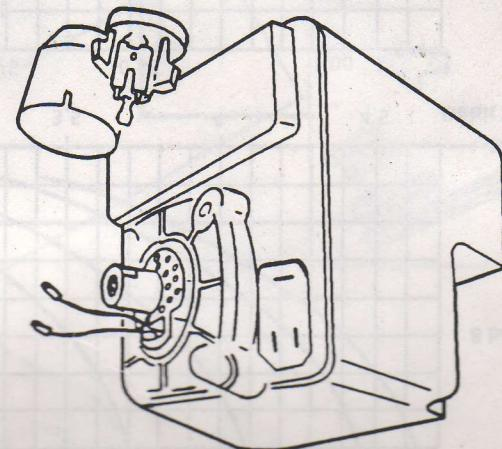
Débrancher les fils haute tension de l'ensemble électrodes.
