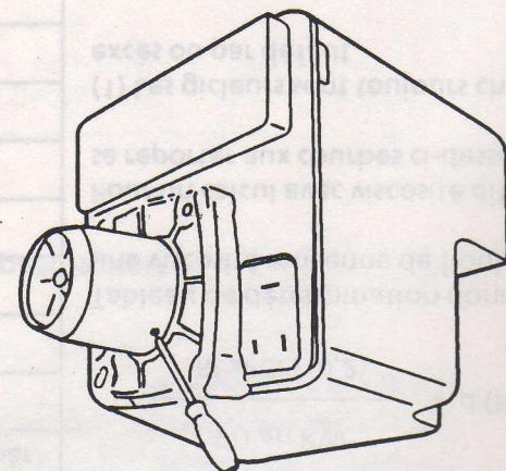
Desserrez la vis de fixation.
