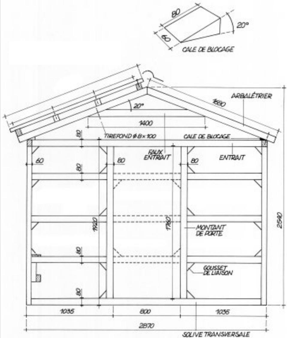
Les entraxes de pannes, supports de la couverture et du bardage, restent
